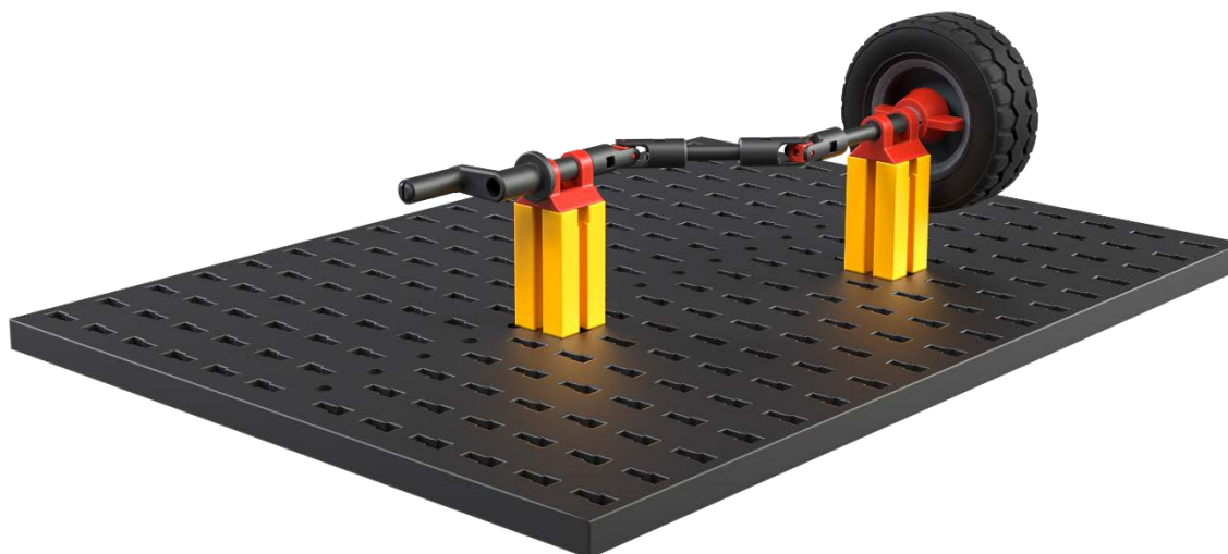
Abb. 4: Kardanwelle mit zwei Kardangelenken
