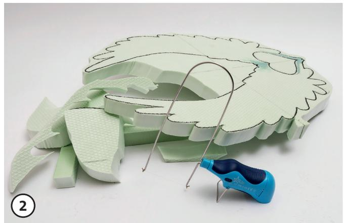
Découper les ailes avec l'appareil de coupe pour polystyrène.
