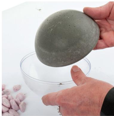
8. Enlevez la moitié de boule extérieure. C'est possible qu'il soit assez difficile de détacher les coupes à cause du ruban adhésif qui a été collé. Si c'est le cas, alors il faut découper la coupe en plastique avec une pince (scie à métaux, à chantourner). Laissez sécher le béton complètement.
